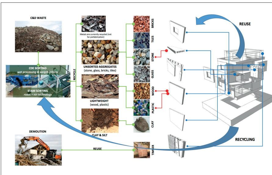
Im Rahmen des EU-finanzierten Forschungsvorhaben **RE4 - REuse and REcycling of CDW materials and structures in energy efficient pREFabricated elements for building REfurbishment and construction** wurde ein Konzept für ein kreislaufgerechtes, energieeffizientes, mehrgeschossiges Wohngebäude auf Basis von Bau- und Abbruchabfällen entwickelt.
